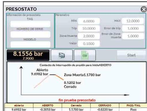
La evaluación de sus presostatos se puede realizar en forma automática.
